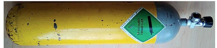
Abb. 3: 10 Liter Druckluftflasche
